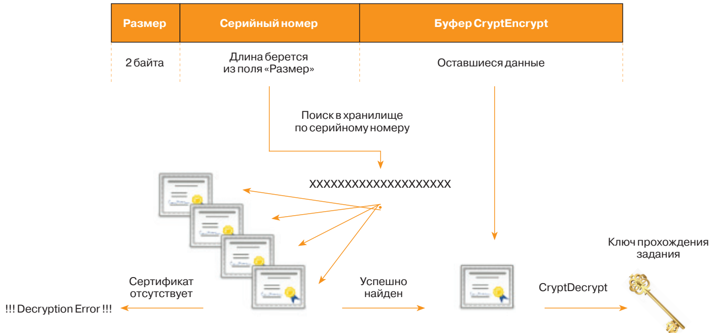
Рис. 8. Алгоритм работы сеттера свойства EncryptedTextBlob ActiveX-компонента NeoQuestActiveX.dll
